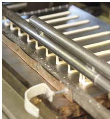
In der Hostienbäckerei wird der angerührte Teig auf den Backplatten verteilt. Jeder Karton enthält etwa 1.600 Stück.
